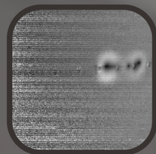
Risserkennung in einer genieteten Luftfahrtstruktur. Links: durch induktiv-angeregte Thermografie nachgewiesene Risse an schadhafte Niete. Rechts: entsprechendes Foto.
