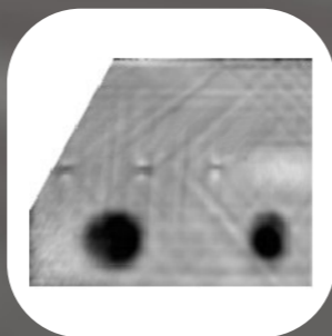
Charakterisierung von kohlefaserverstärkten Strukturen mit Impactschäden.
