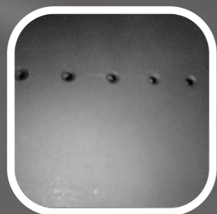
Risserkennung in einer genieteten Luftfahrtstruktur. Links: durch induktiv-angeregte Thermografie nachgewiesene Risse an schadhafte Niete. Rechts: entsprechendes Foto.
